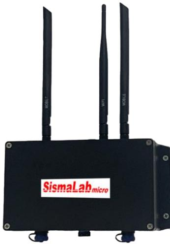
Fornisce alimentazione e gestisce fino a sei trasduttori indipendenti, effettua periodicamente la misura, calcola la trasformata di Fourier e ne trasmette i dati al cloud tramite la rete Lorawan.
